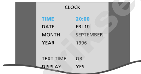
Menu for indstilling af uret – punktet TEXT TIME (Tekst-TV-tid) angiver synkronisering med Tekst-TV. Punktet DISPLAY angiver, om uret vil blive vist i displayet på BeoCenter AV5
